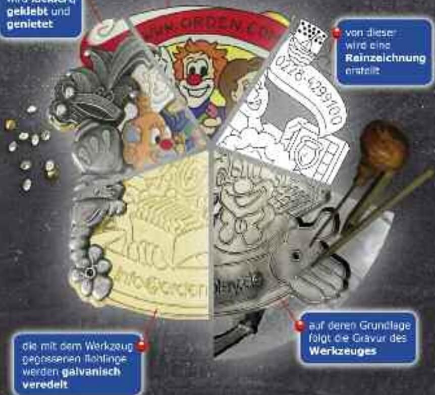
die mit dem Werkzeug gegossenen **Fließlinge** werden **galvanisch veredelt**
